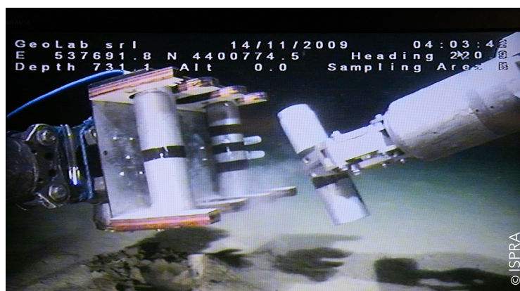
Échantillonnage de sédiment avec un ROV dans le fond marin profond.
