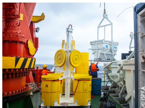
Racks spécifiques où sont des fûts se trouvant au fond de la mer ont été récupérés par un ROV
