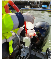
Bouteille pour échantillonner l'eau en dessous de la surface
