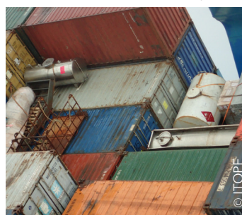
Conteneurs de marchandises dangereuses à bord
