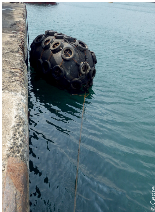
Garde-boues Yokohama utilisés pour permettre l'approche entre deux navires
