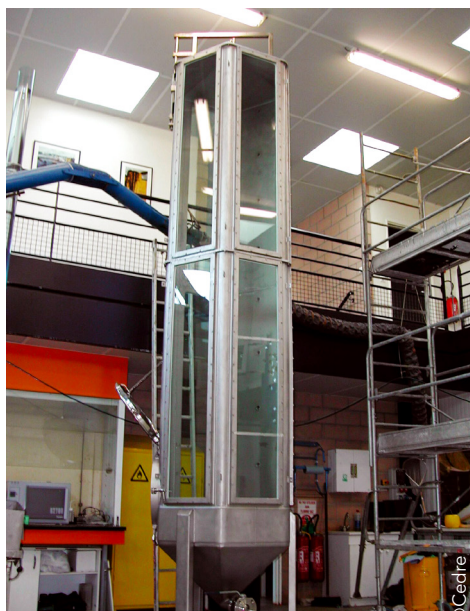
Colonne d'expérimentation étudiant le comportement d'un produit chimique (ou hydrocarbure) alors qu'il s'élève ou plonge dans la colonne d'eau
