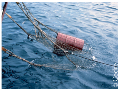
Hissage d'un fût avec un filet de récupération
