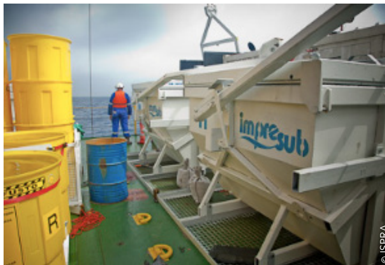
Racks spécifiques et barils de récupération conçus pour recueillir les barils dans le fond marin
